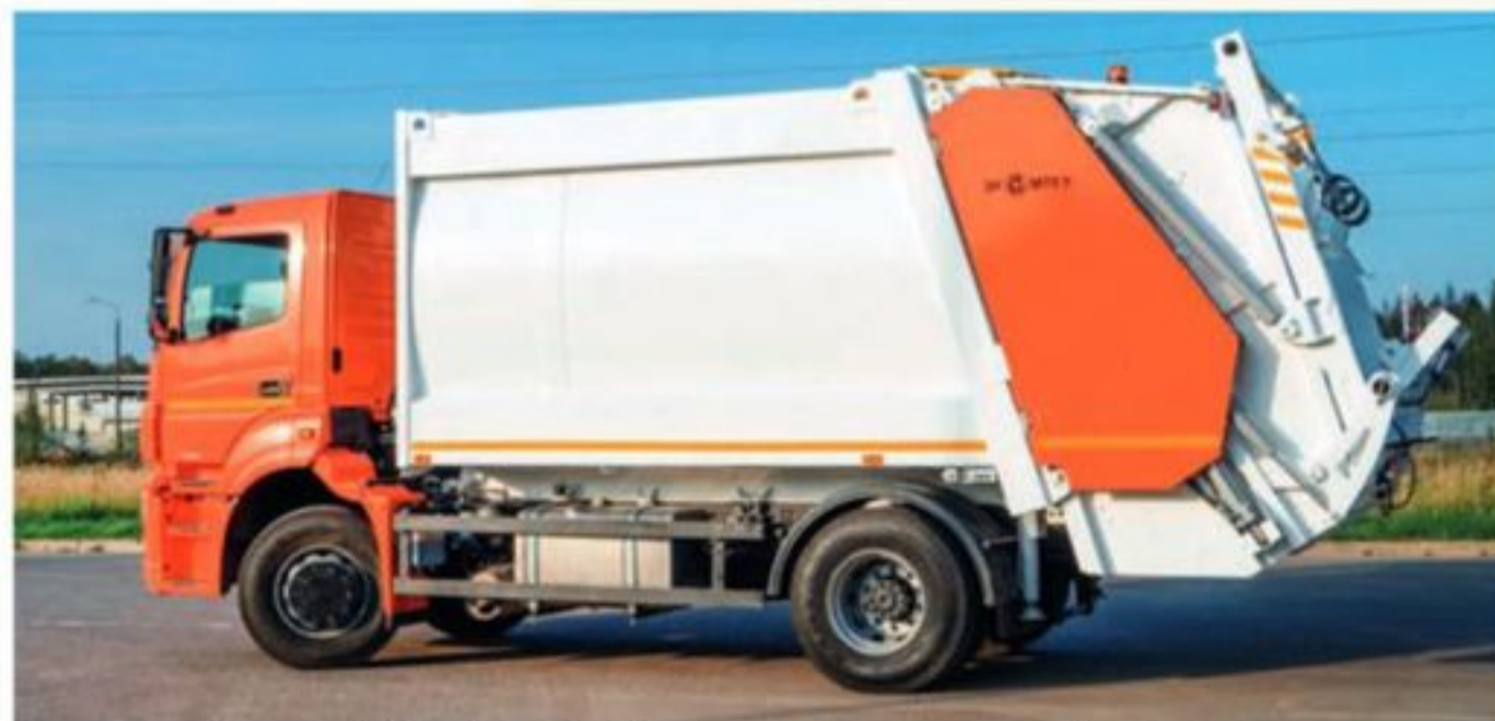
Мусоровоз «Экомтех» МКЗ-50-16 с 16-кубовым кузовом на шасси новой двухосной модели КАМАЗа
