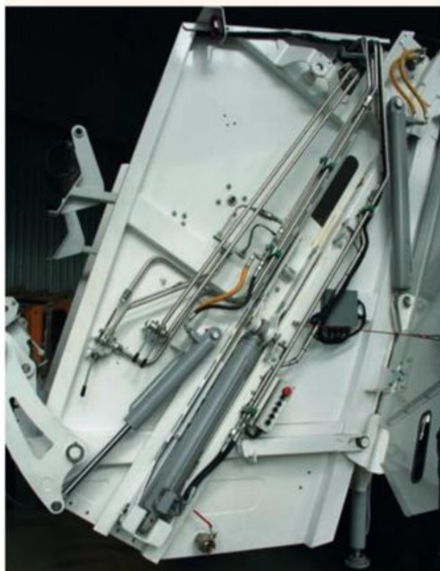
Грамотная, эстетически красивая прокладка гидравлических соединений – одна из визитных карточек мусоровозов «Экомтех»
