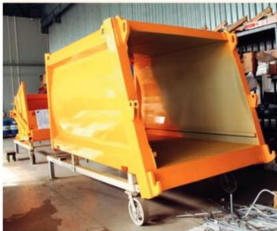
Сваренные и окрашенные кузова будущих мусоровозов
